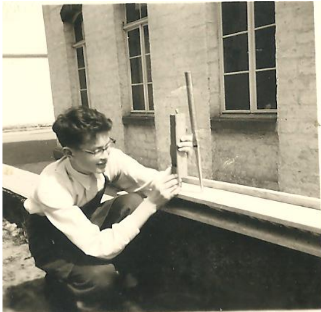
Abb. 2 Aufsetzen der Pfeifen auf die Windlade
